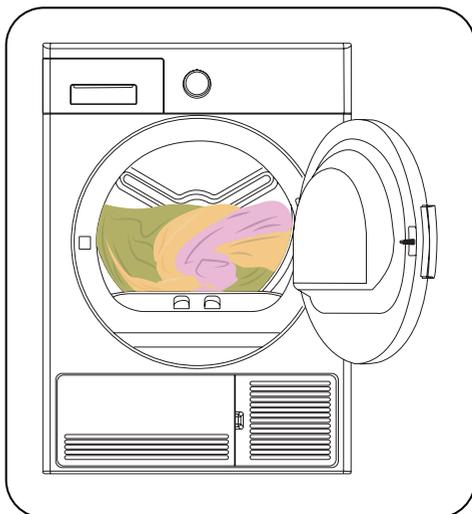
**⚠ IMPORTANTE:** Não é recomendável que carregue a máquina de secar com mais roupa do que a quantidade indicada na imagem. Quando estiver sobrecarregada, o desempenho de secagem da máquina de secar irá diminuir e a máquina de secar e a roupa poderão ficar danificadas.
