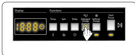
**NOTA:** Quando a função do detergente líquido (dosagem automática) é desativada, é necessário utilizar detergente em pó para ciclos de lavagem. Para tal, deve colocar detergente no compartimento do detergente em pó.
