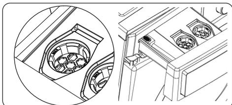
Apenas substâncias como o amaciador de roupa podem ser utilizadas neste doseador (siga a quantidade e o tipo conforme recomendado pelo fabricante). O amaciador de roupa utilizado para lavandaria pode por vezes permanecer neste dispensador. Isto acontece porque o amaciador de roupa não é uma substância fluida. Recomenda-se a utilização de amaciadores de roupa líquidos com menos viscosidade ou a utilização do amaciador após ser diluído.
