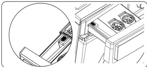
Se pretender utilizar detergente em pó para o ciclo de lavagem, desative a função de dosagem automática e utilize o compartimento do detergente em pó.
