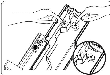
**!** **CUIDADO:** A parte marcada "UP" deve ser colocada na câmara com a parte virada para cima.
