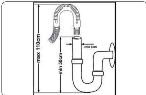
Ligue a mangueira de escoamento da água diretamente ao orifício de escoamento da água ou à saída do lavatório. Esta ligação deve ter um mínimo de 50 cm e um máximo de 110 cm a partir do chão.
